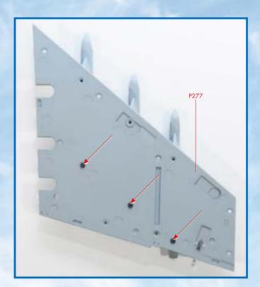
Зафиксируйте пилоны винтами ММ с внутренней стороны обшивки правой консоли крыла (Р277), как показано на снимке.
