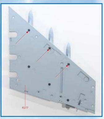
**6** Затем зафиксируйте пилоны винтами СМ, как показано на снимке.
