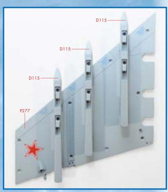
**4** Затем установите пилоны (D115) на внешней поверхности обшивки правой консоли крыла (P277), как показано на снимке.
